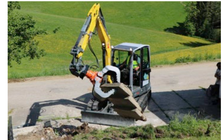
Godet orientable avec flexibles hydrauliques et accouplements
