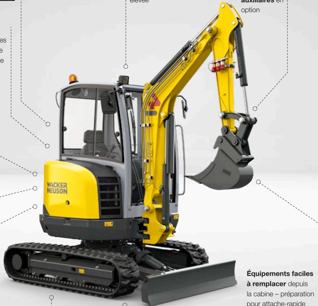
**Le mécanisme de pare-brise avant innovant** permet différentes positions d'ouverture – pour un confort et une sécurité maximale dans toutes les situations de travail.
