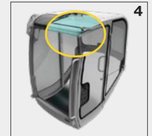
Si nécessaire, les deux vitrages peuvent être relevés sous le toit de la cabine, ils sont ainsi rangés dans un endroit sûr.
