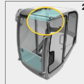
La vitre supérieure du pare-brise peut être relevée sous le toit de la cabine. La vitre inférieure offre une protection contre les projections d'eau.
