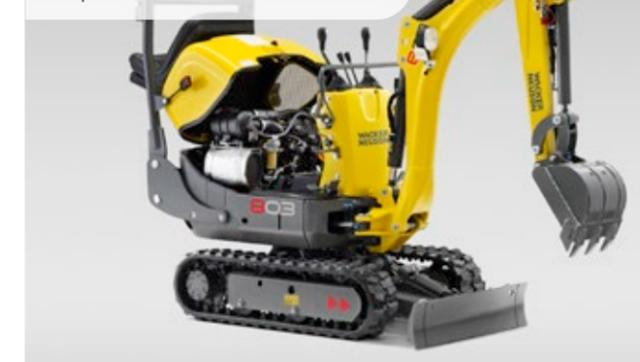
Transmission la plus puissante de sa catégorie, allée à un système hydraulique avec répartition de débit indépendant de la charge à déplacer (LUDV) pour une performance maximale et des manoeuvres précises
