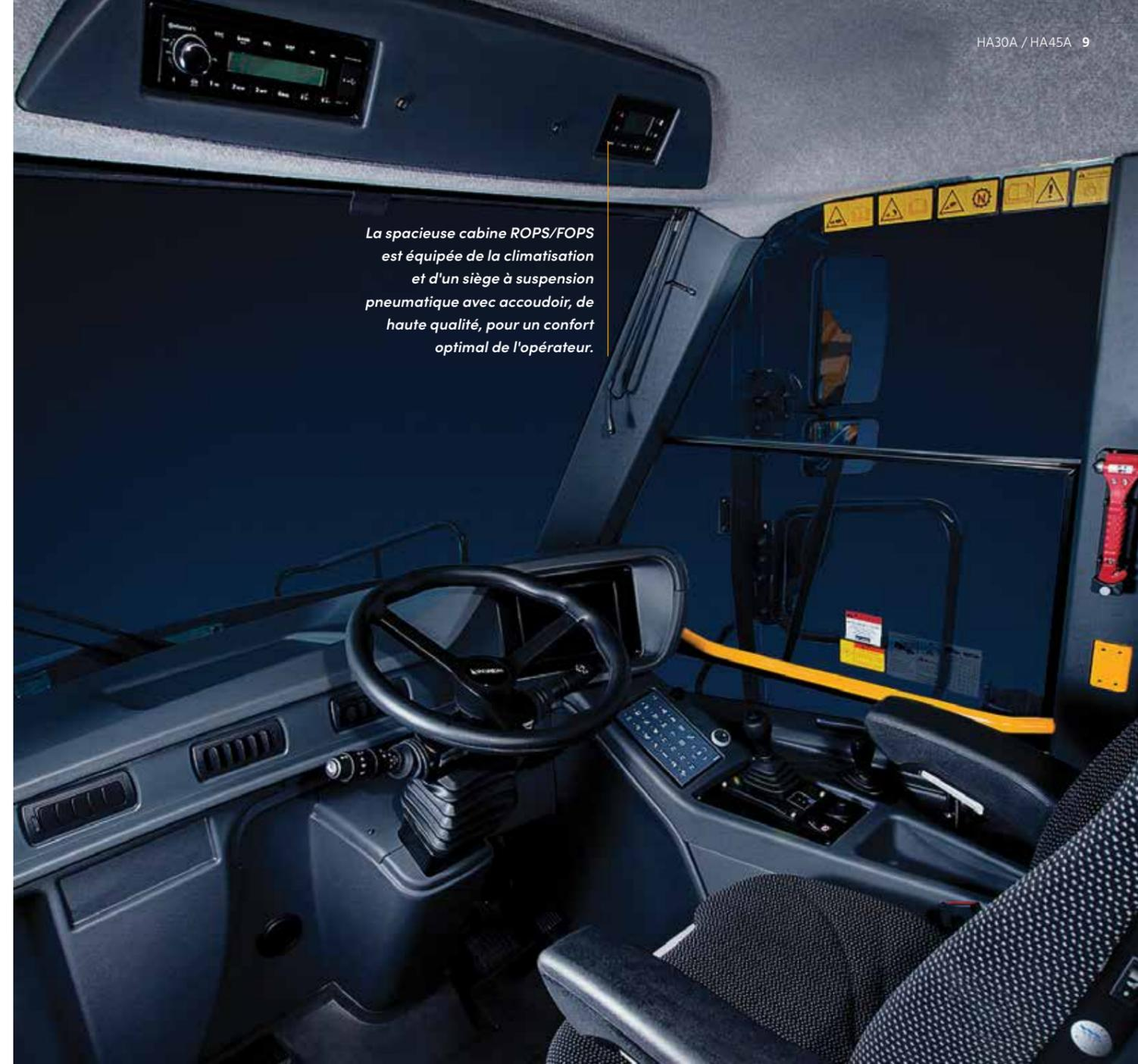
La spacieuse cabine ROPS/FOPS est équipée de la climatisation et d'un siège à suspension pneumatique avec accoudoir, de haute qualité, pour un confort optimal de l'opérateur.
